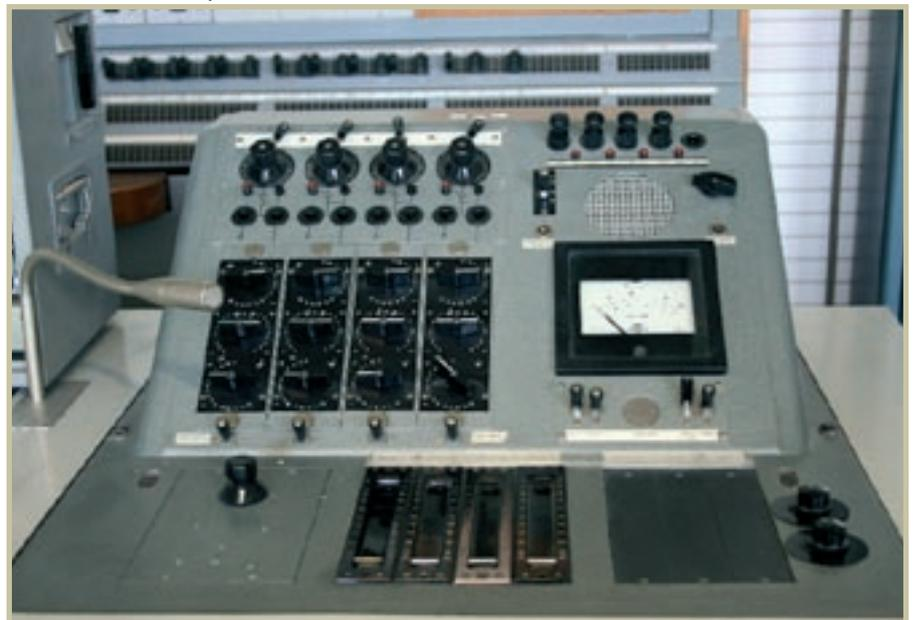
Das Hallgitter wurde von einem elektrodynamischen System angeregt und mit einem piezoelektrischen Abtaster aufgenommen. Es waren Hallzeiten bis zu sechs Sekunden möglich, welche stufenlos dem Originalsignal zugemischt wurden.
